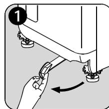
Для перемещения стиральной машины достаточно установить ее на колесики, вытянув до упора справа налево рычаг, предусмотренный в
